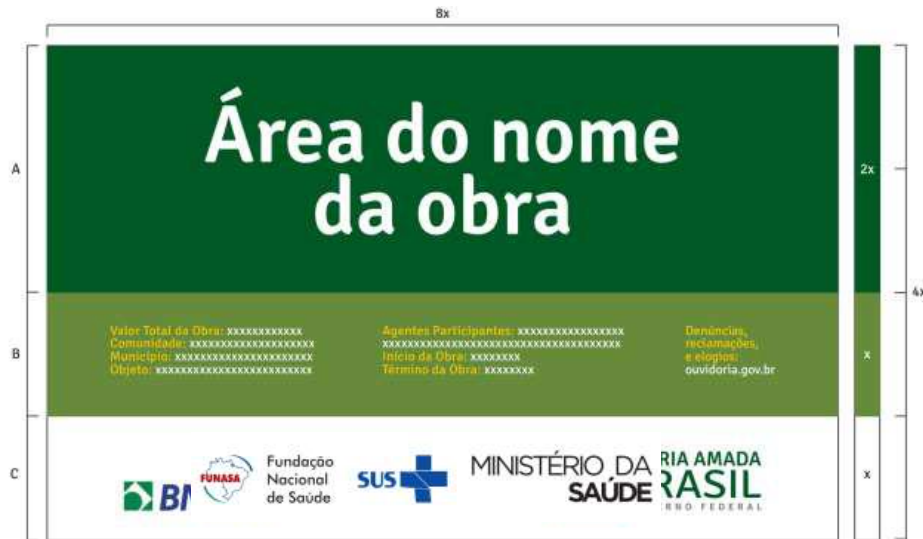
Figura 1: Modelo de Placa da Obra.
