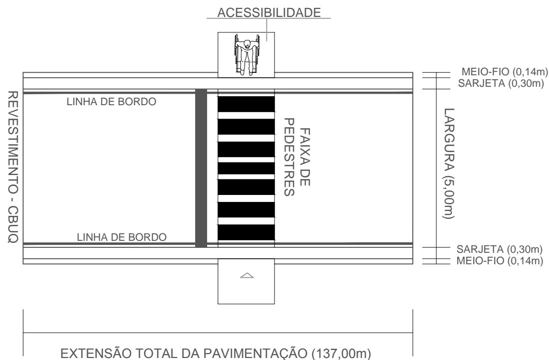
Vista Superior - Pavimento Escala 1/100
