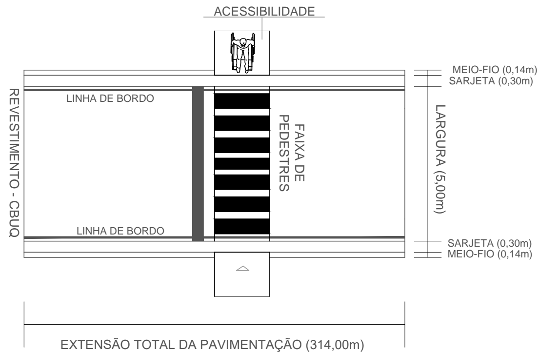
Vista Superior - Pavimento Escala 1/100
