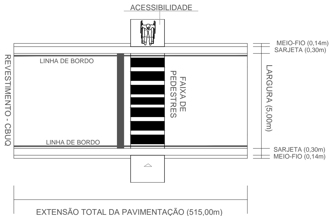
Vista Superior - Pavimento Escala 1/100
