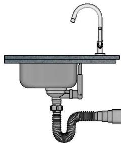
BANCADA EM GRANITO ANDORINHA COM RODA SAIA DE 4cm, COM CUBA DE 40x40cm, INCLUSIVE SIFÃO, VÁLVULA E ENGATES CROMADOS E CUBA DE AÇO INOX. TORNEIRA CROMADA DE MESA PARA PIA, BICA ALTA, ACIONAMENTO POR ALAVANCA DE COTOVELO.
