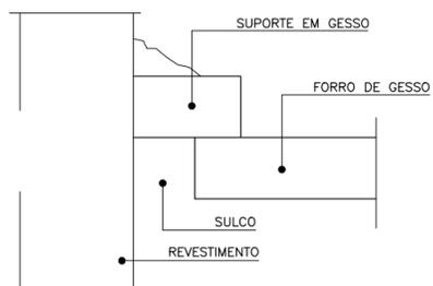
**Detalhe -Junta de Dilatação**
