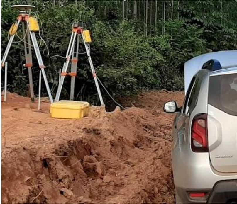
Figura 04-Fização dos Marcos de Levantamento
